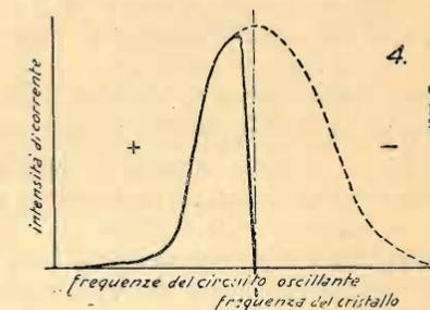
Ricordiamo che la condizione necessaria perchè abbiano a formarsi le oscillazioni è che esista una capacità fra placca e griglia. Questo ci dice che mentre i triodi sono adatti a tale funzione, le schermate ed i pentodi di AF sono assolutamente inadatti essendosi in essi ridotta ad un valore quasi nullo l'influenza fra placca e griglia.
