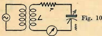
aumentandola, rispetto alla  $f_0$  e sino a quando non si legge nello strumento nuovamente un valore di corrente uguale a 0,7 I. In possesso di questi dati si può calcolare subito il valore di Q dato dalla seguente espressione
