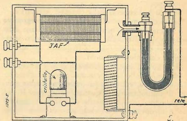
La fig. 5 illustra appunto come deve essere realizzato tale dispositivo. Il recipiente di rame a tenuta d'aria è esternamente protetto da copertura di amianto.
