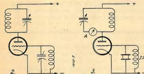
L'inserzione del cristallo, viene fatta a tale scopo nel modo illustrato in fig. 3. Il circuito di oscillatore più spesso usato è l'Armstrong di fig. 2.
