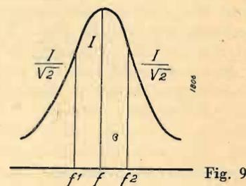
Alla frequenza di risonanza  $f_0$  corrisponde il valore massimo  $I$  di corrente. Il circuito oscillante della fig. 10 è il circuito preso in esame; in esso l'induttanza è accoppiata al solito generatore di segnali ed il circuito è completato dal termogalvanometro  $A$ ; la  $R$  rappresenterebbe la resistenza in serie del circuito. Regolata l'eterodina alla frequenza  $f_0$  in corrispon-
