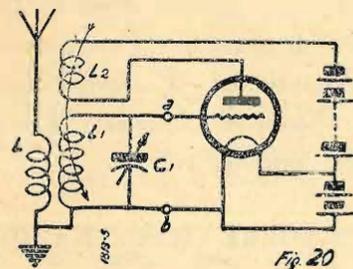
Il segnale proveniente dall'aereo viene mandato per via magnetica al circuito oscillante  $L_1 C_1$ , il potenziale oscillante che si forma agli estremi di esso è applicato fra griglia e filamento di una valvola (ciò che abbiamo già visto in diversi altri casi).
