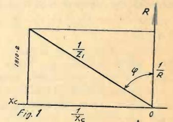
Per applicare il teorema di Cartesio si deve conoscere prima l'angolo di sfasamento della impedenza del parallelo precedentemente calcolata.
